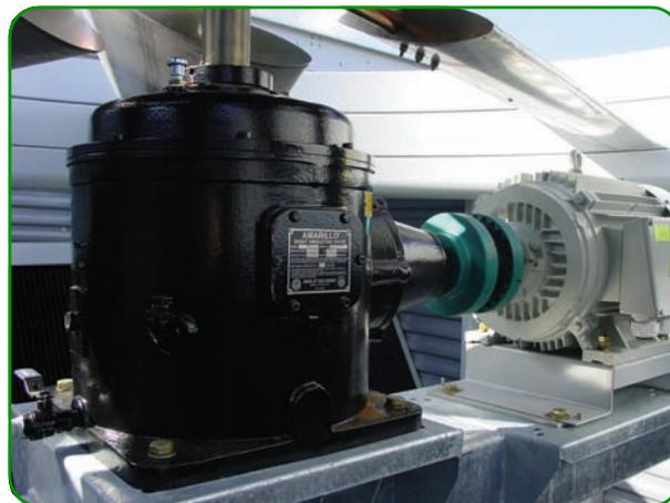
Система зубчатой передачи, сопряженный электромотор
